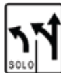
(R-5-3) SEÑAL CARRIL EXCLUSIVO PARA VOLTEO OBLIGADO Y CARRIL DE VOLTEO CON SEGUIR DE FRENTE
