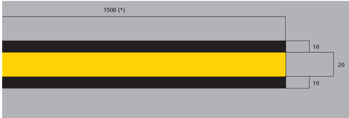
Fig. 38 Dimensiones de la barra de alineación.
