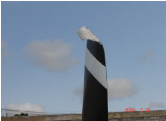
DAÑO EN LAS PUNTAS DE LA HELICE DERECHA DE LA AERONAVE PIPER PA34-200T, OB-1564.
