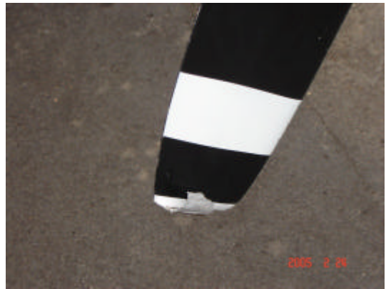
DAÑO EN LAS PUNTAS DE LA HELICE DERECHA DE LA AERONAVE PIPER PA34-200T, OB-1564.
