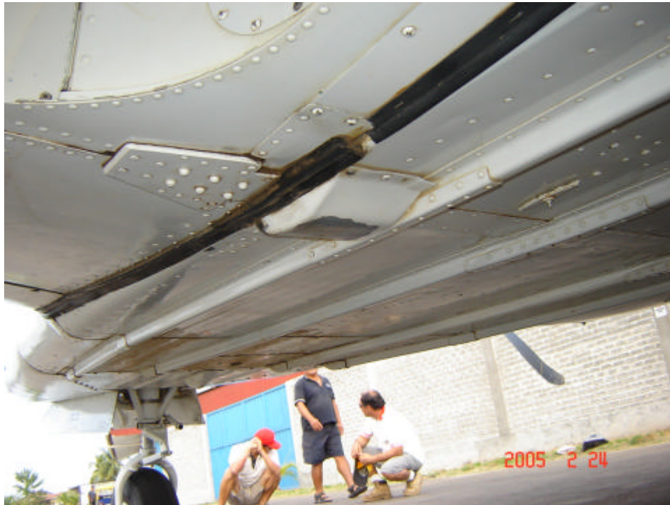
DAÑO EN LA PISADERA DE ACCESO DE LOS PASAJEROS A LA AERONAVE
