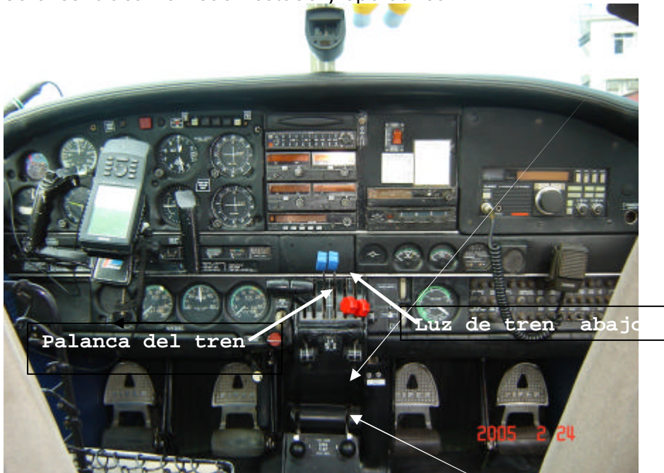
FOTO DEL PANEL DE INSTRUMENTOS DENTRO DE LA CABINA DE MANDO
