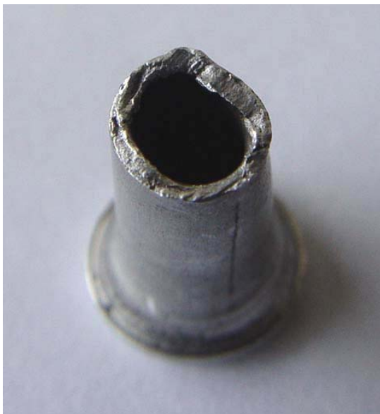
Detalle de las fracturas de la línea hidráulica del cilindro actuador del tren principal derecho.
