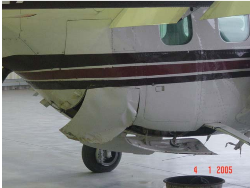
DAÑOS A AMBAS COMPUERTAS DEL TREN PRINCIPAL DE ATERRIZAJE LADO DERECHO.
