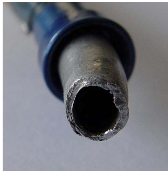
Detalle de las fracturas de la línea hidráulica del cilindro actuador del tren principal derecho.
