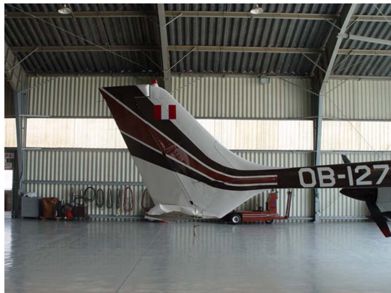
DAÑO AL ESTABILIZADOR DERECHO DE LA AERONAVE CESSNA T337H, OB-1274.
