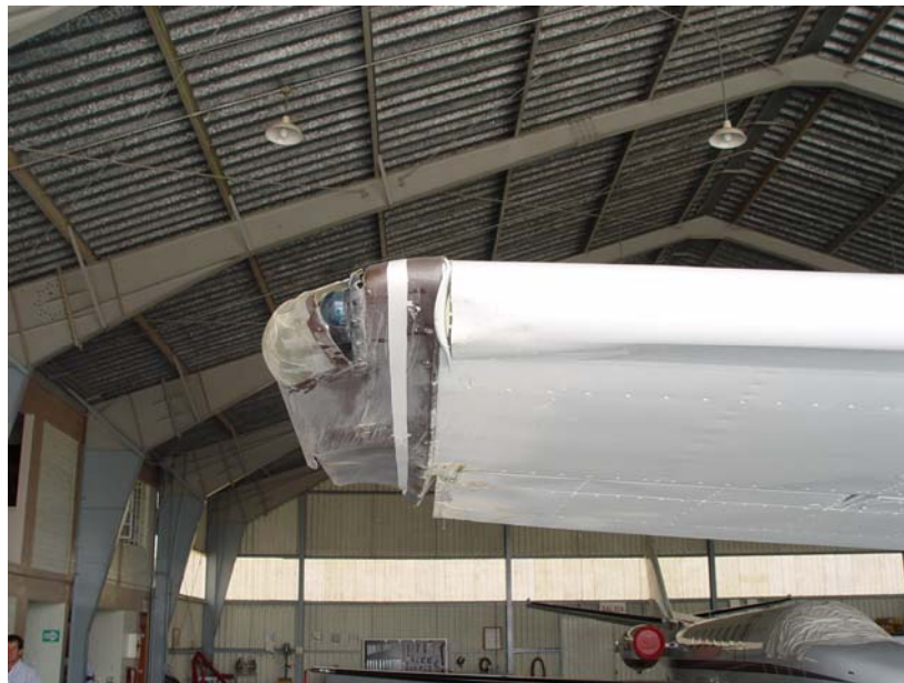
DAÑO AL TIP Y AL ALERÓN DEL ALA DERECHA.
