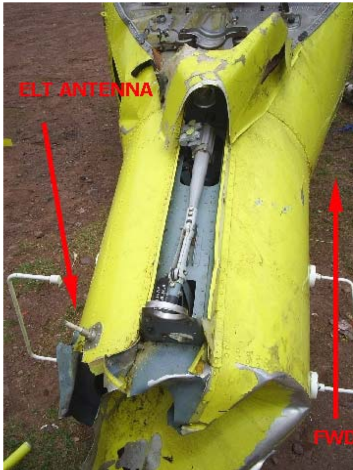
Fotografía de la antena rota del ELT en los restos recuperados de la aeronave.
