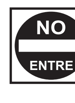
R-38 PROHIBICIÓN DE INGRESO
