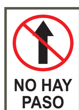
R-4 PROHIBIDO SEGUIR DE FRENTE
