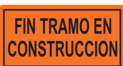
RC-3 FIN DE TRAMO EN CONSTRUCCION
